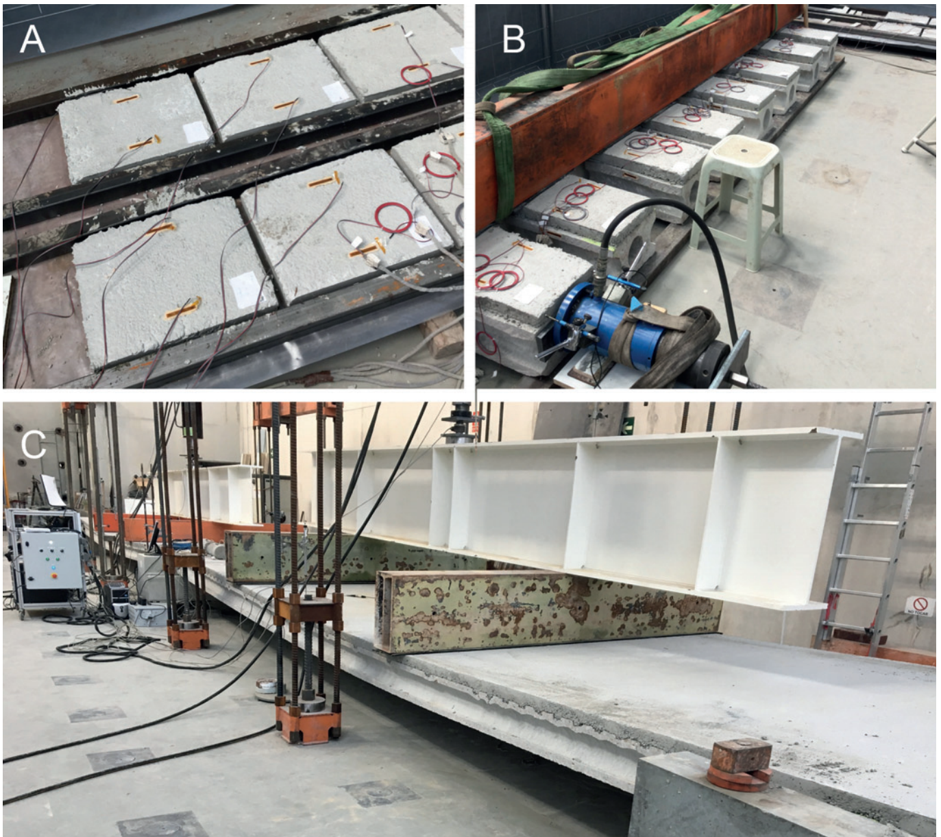
3: A) Badania swobodnego skurczu próbek nadbetonu o różnym składzie; B) Badania poziomej wytrzymałości na ścinanie małych próbek; C) Badania w skali rzeczywistej (przy wysokim obciążeniu) dwuprzęsłowego stropu wykonanego z płyt kanałowych z wrębami.
